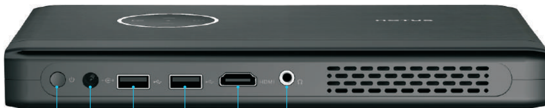
电源键 电源接口 DC 19V USB① USB② HDMI 音频
